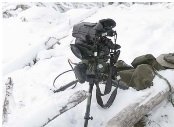
Tämä toteemipaalu on Ruotsin tulenjohtajien käyttämä maalinpaikannuslaite. Alhaalta ylöspäin lueteltuna gonio-metri suunnan mittausta varten, lämpökamera sekä laseretäisyysmittari. Meillehän tähän tarkoitukseen kehitettiin kotimaassa kompakti kädessä pidettävä MPL-15.
